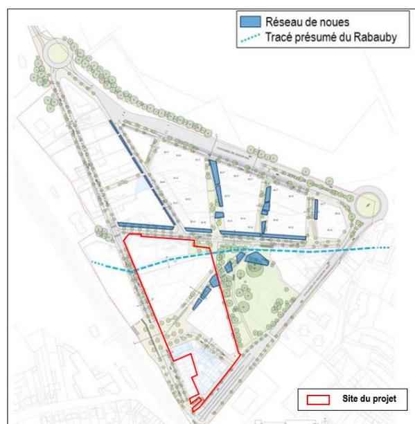
**Figure 45 : Schéma de principe de localisation des noues (JNC, 2018)**
